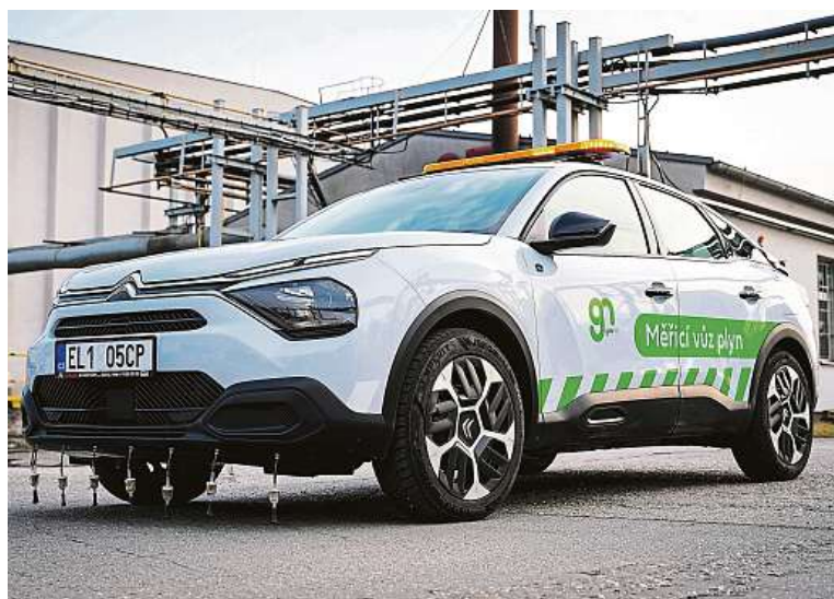
Elektrické vozidlo pro mobilní kontrolu plynovodů.
