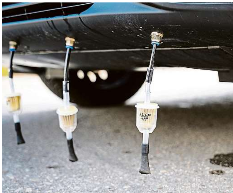
Auta jsou vpředu v nárazníku osazena nasávacími sondami.
