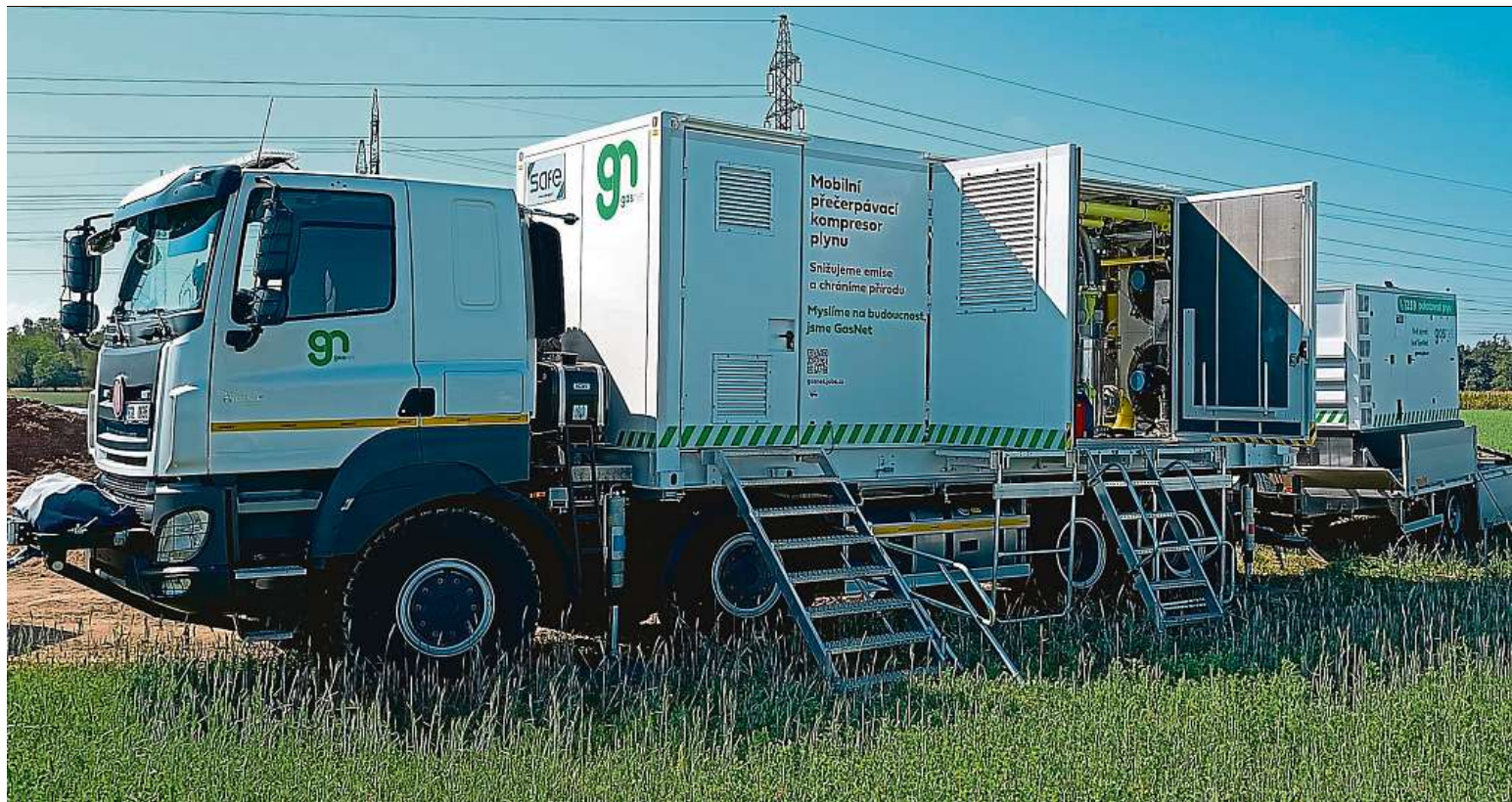
Mobilní kompresor pro přečerpávání zemního plynu výrazně snižuje emisní stopu plynárenských prací
